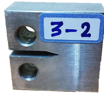
شکل ۵ - نمونه آماده شده آزمایش K1c
