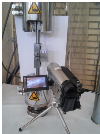
شکل ۸ - نحوه استقرار نمونه جهت انجام آزمون چقرمگی شکست
