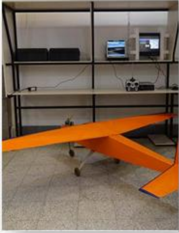
شکل ۶ - آزمایشگاه سخت‌افزار در حلقه به همراه هواپیمای سراج ۱۱۰
